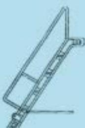
Для посадки и высадки пассажиров, членов экипажа маломерные суда с высотой надводного борта свыше 0,5 метра должны быть оборудованы трапами (сходнями) с леерным ограждением.
