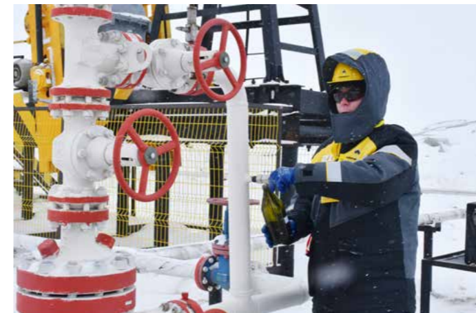
Отбор пробы нефти - важная часть работы оператора по добыче нефти и газа
