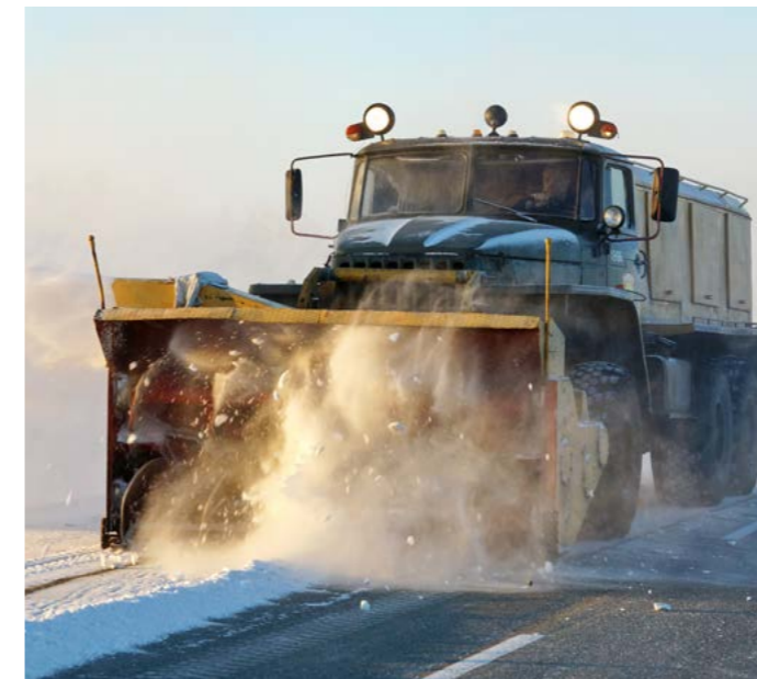
Комбинированная дорожная машина (КДМ) выполняет несколько функций: от уборки снега до обработки дорог реагентами
