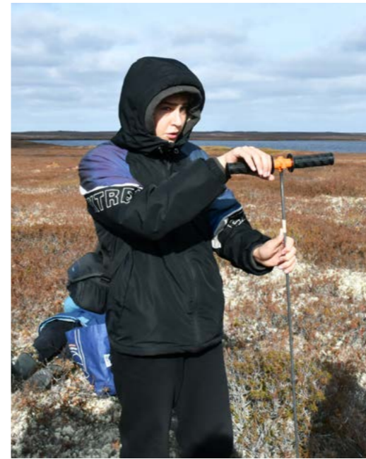
Анатолий Фуника измерял глубину оттаивания грунта
