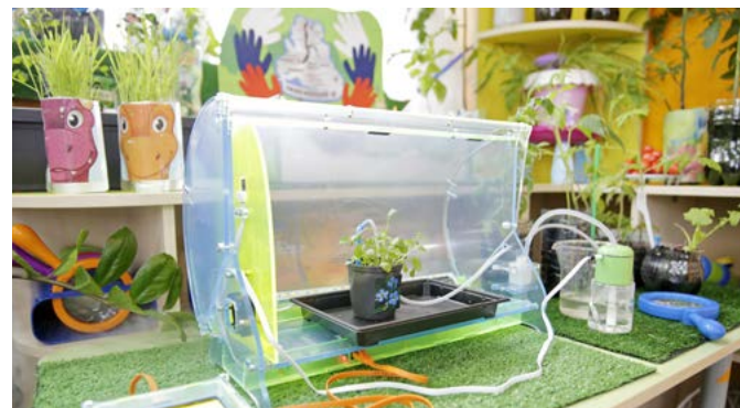
С помощью «чудо-грядки» ребята могут отслеживать температуру и влажность воздуха, а также управлять поливом
