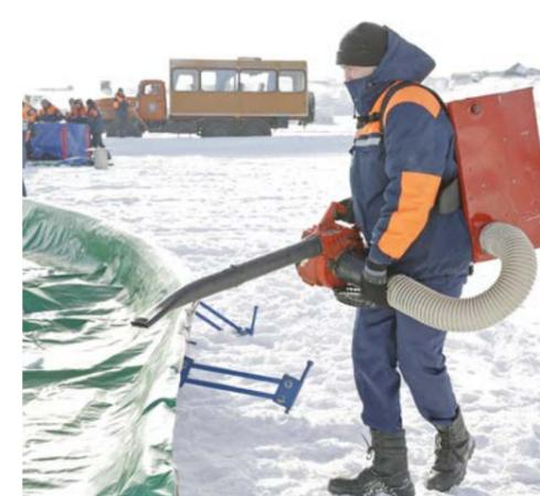
Распыляемый сорбент используется для ликвидации последствий разлива нефтепродукта
