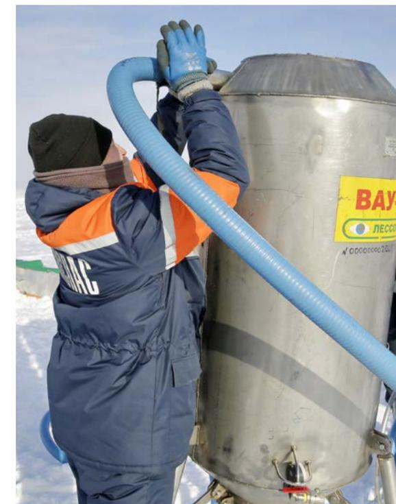
Вакуумная установка ВАУ-1 предназначена для сбора жидкости при ликвидации разливов нефти
