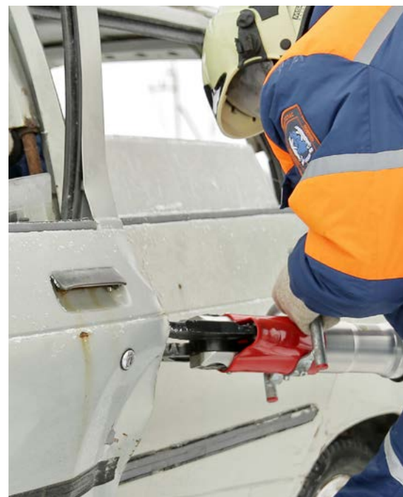
Для деблокировки дверей автомобиля спасатели использовали гидравлические ножницы
