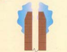
ПРИЧИНЫ НАРУШЕНИЯ ТЯГИ: а - обмерзание оголовка;
