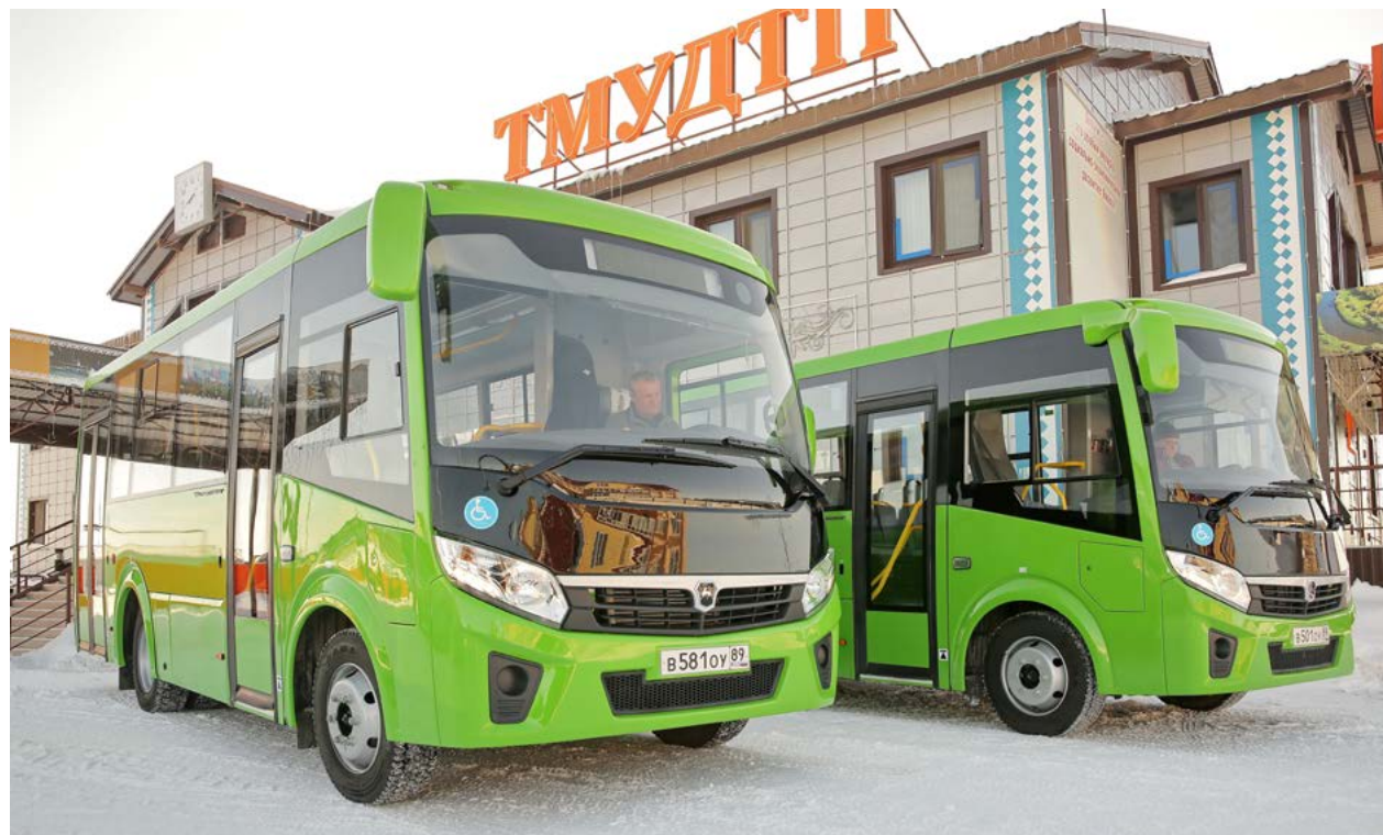
У новых автобусов двойное остекление и дополнительные печки в салоне. Они предназначены для эксплуатации в условиях Крайнего Севера
