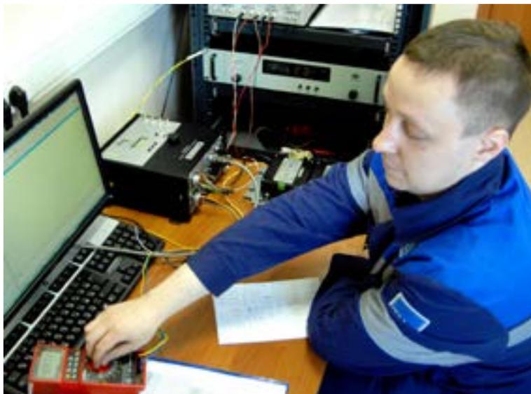
Слесарь по КИПиА лаборатории метрологического обеспечения службы метрологии УАиМО Станислав Фетисов проводит проверку датчиков вибрации, привезённых с ГП-4
