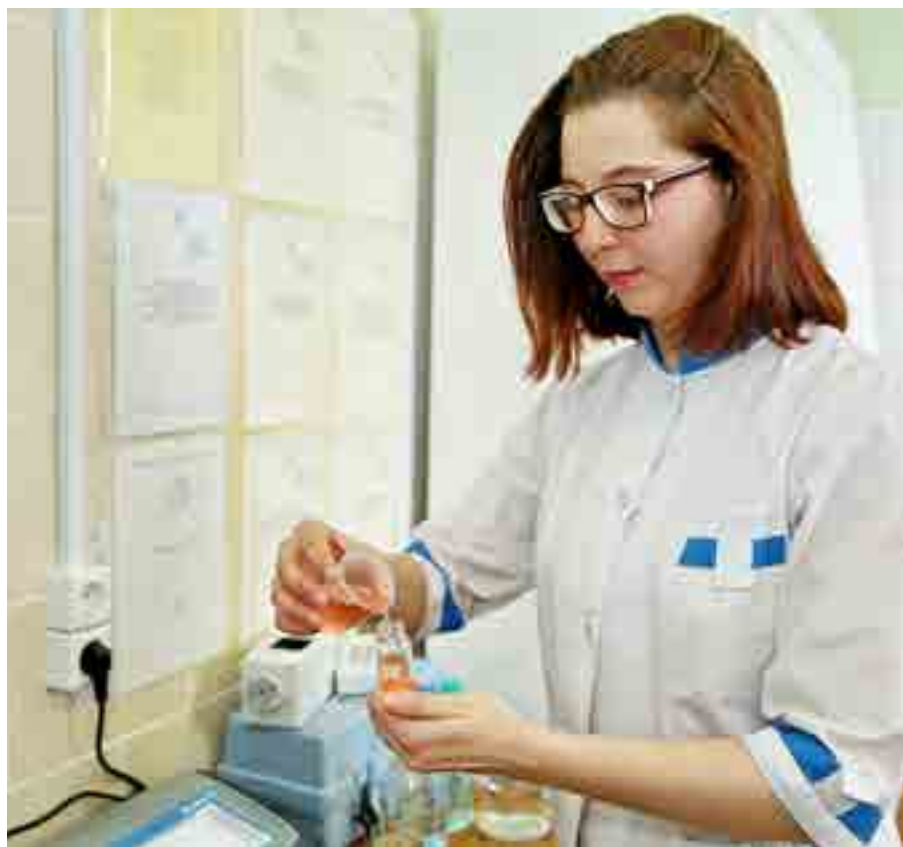
Лаборант химического анализа Екатерина Отряхина с помощью реактивов проверяет воду на наличие алюминия, железа и марганца
